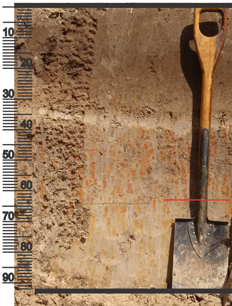
Figura 1.7 – Exemplo de imagem do perfil do solo com as indicações do limite inferior do 3º horizonte (linha vermelha) e trena de referência, usado nas competições virtuais.
